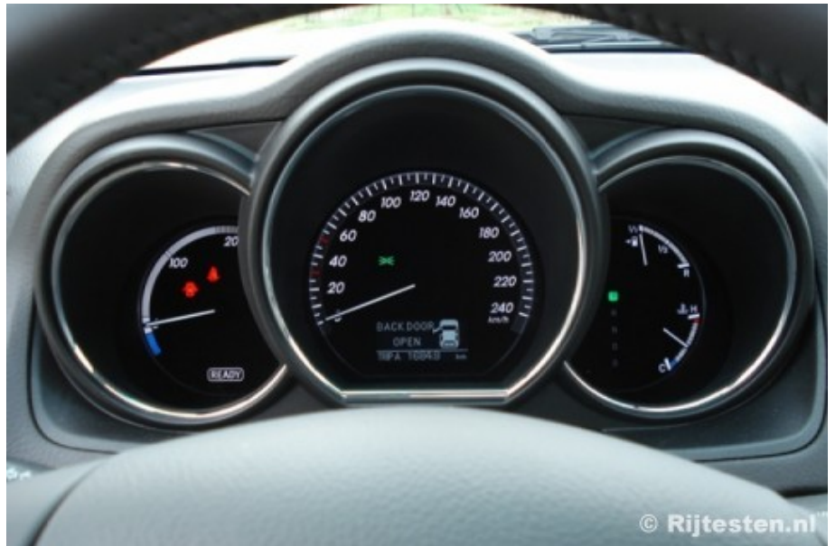
Links geen toerenteller maar een kilowatt meter voor de elektromotoren.
