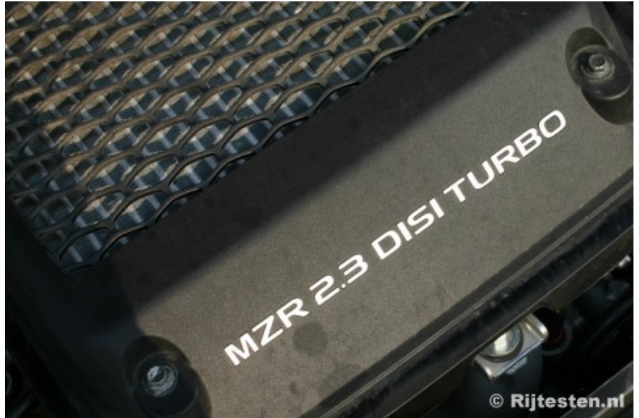
Met andere woorden: het is een direct ingespoten 2,3 liter turbomotor.
